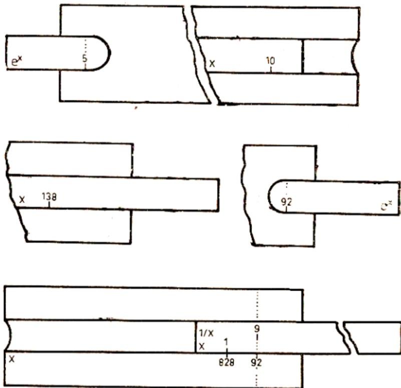
2. Přesněji – šoupátko obrátíme a hodnotu 5 stupnice  $e^x$  nastavíme na 1 stupnice  $x$ , index okénka přesuneme na 138 stupnice  $x$  a pod tímto indexem odečteme výsledek mocniny 9,2 na stupnici  $e^x$ . Tento částečný výsledek vynásobíte hodnotou 0,9 způsobem podle stati III (viz předešlý obrázek).
